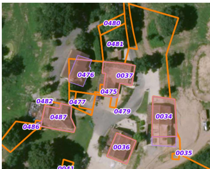
Décalage observé sur le bâti
