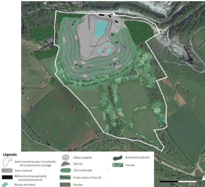
**Figure 3 : projet schématique de remise en état – extrait de l'étude d'impact – réalisation l'Artifex**
